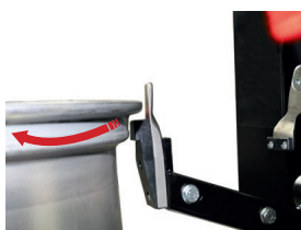
Montaggio tallone inferiore Bottom bead mount
