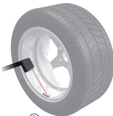
② Applicazione guidata dei pesi adesivi. Automatic apply of stick-on weights.
