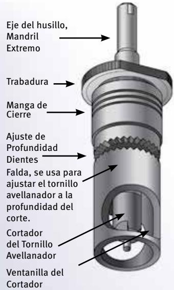
**NOTA:** La falda se mantiene estacionaria cuando está en contacto con la superficie del cortador, permitiendo al operario ver el cortador.
