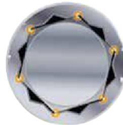
Llave convencional de 12 puntos y el punto de contacto que hace en una tuerca o perno. La esquina se puede redondear bajo cargas pesadas causando que la llave se resbale.
