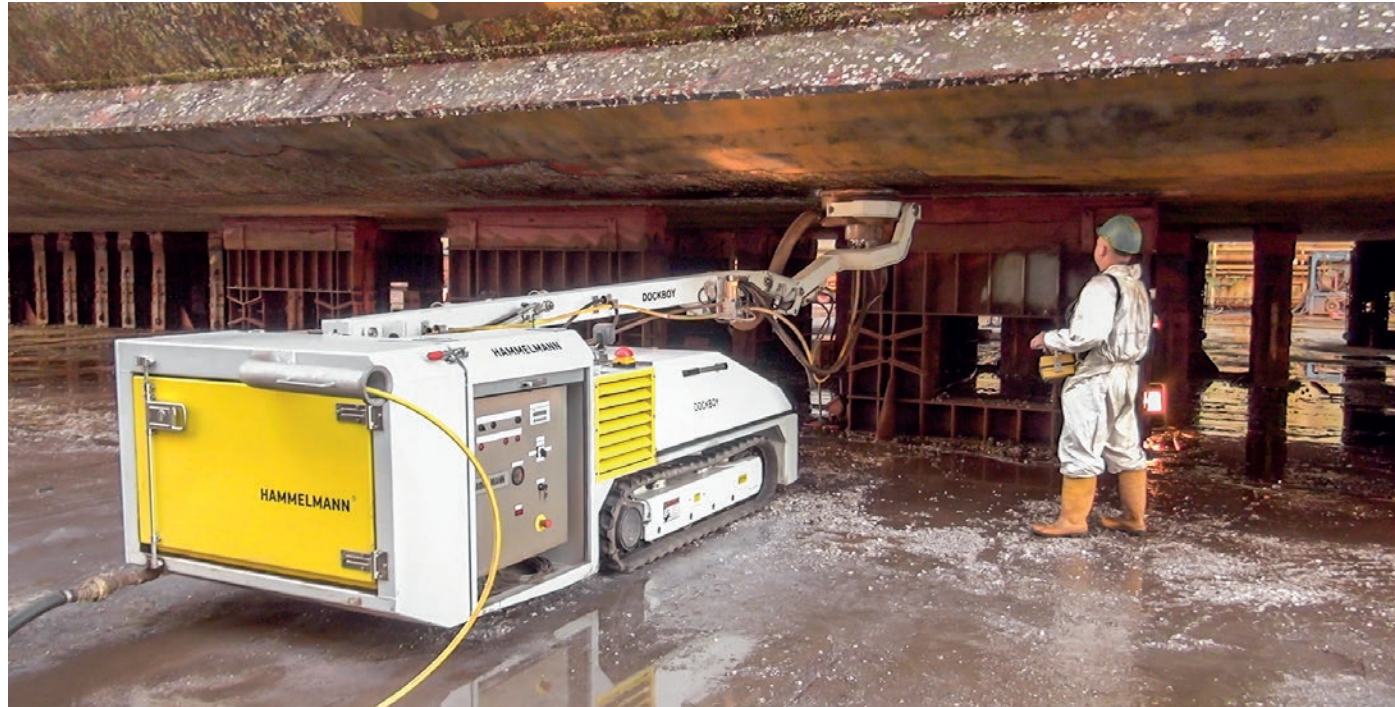
Dockboy es el vehículo semiautomático para trabajar en la parte baja del casco del barco y superficies similares.
