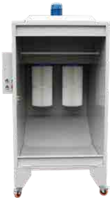
Cabina de Pintura
