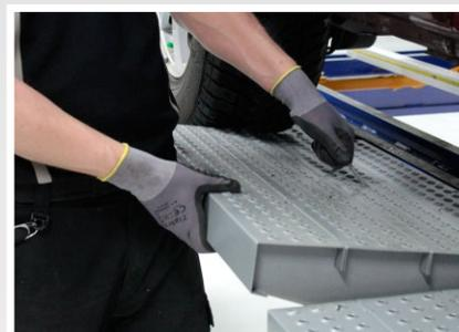
*Las secciones de rampa desmontables se desenganchan fácilmente para proporcionar un mejor acceso al vehículo.*
