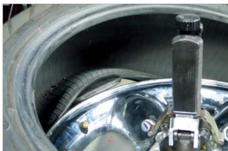
Desmontaje rápido del talón inferior con el disco destalonador. De manera rápida y sencilla.
