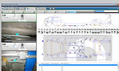
Mida y repare el vehículo según los puntos de medición que ha seleccionado. Introduzca los valores e imprima o guarde el informe
